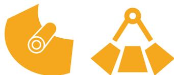
Pequena calha parabólica (esquerda) e linear Fresnel (direita) pode fornecer calor a temperaturas entre 100 °C to 250 °C.
