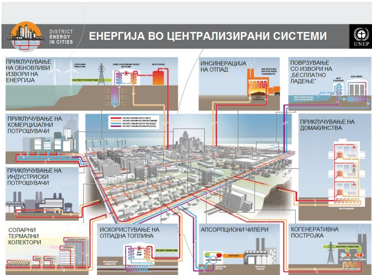
Слика 66: Компоненти на поголем систем за централно греење (Извор: UNEP, www.districtenergyinitiative.org )
