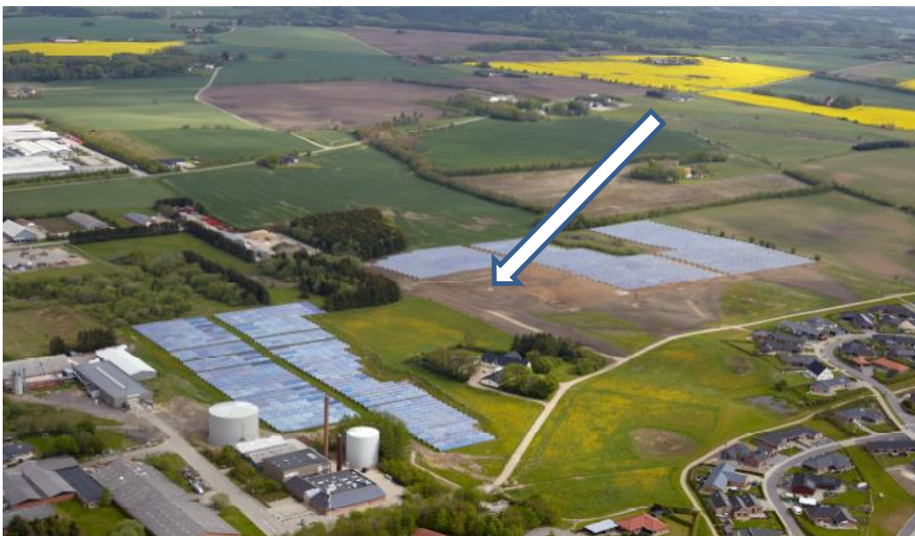
Слика 46: Резервоар во облик на бунар заедно со соларни термални колектори интегрирани во систем за централно греење, Бредскуп, Данска (Извор: PlanEnergi)
