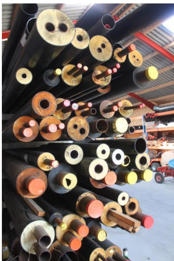
Слика 50: Примероци на единечни и двојни челични цевки (лево) и двојни полимерни цевки (десно) (Извор: Rutz D.)
