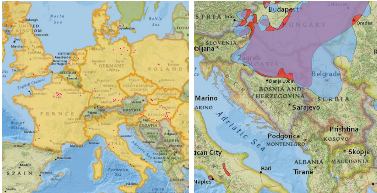
Слика 30: Мапи на постоечките системи за централно греење (црвени точки) со геотермална енергија (лево) и потенцијалните системи (десно); Легенда: температура > 50°C на 1000 m длабочина (сино) и температура > 90°C на 2000 m (црвено); виолетовата боја укажува на преклопување на двете области. (Извор: http://map.mfpi.hu/geo_DH/ )
