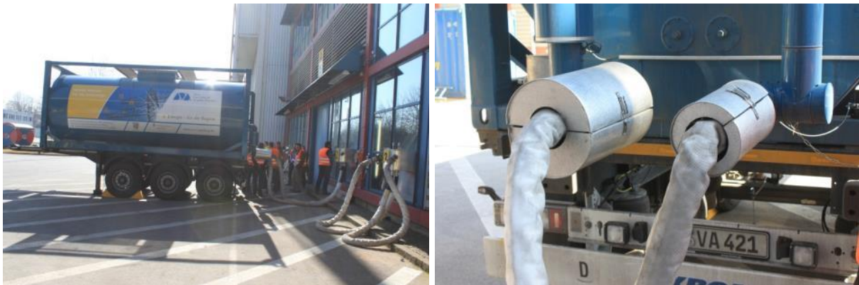
Слика 42: Контејнер за складирање на топлинска енергија кај постројка за согорување на отпад (Аугсбург, Германија) (Извор: Rutz D.)
