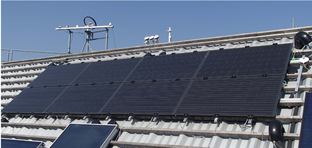
Abbildung 45: Testanlage am SPF. 2 PV-Module am linken Feldrand und 6 PVT-Module mit gleichen elektrischen Spezifikationen.
