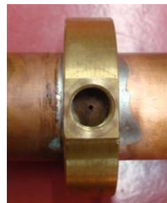
Abbildung 28: Anschlussstück mit Messingring, Mini-Kugelhahn und flexibler transparenter Leitung (links), Messsonde mit 1 mm Ringbohrung (rechts)
