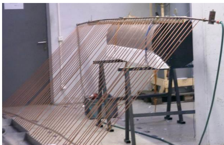
Abbildung 55: Verschaltung der Rohrregister im Labor von GREENNoneTEC, wo die Volumenströme der einzelnen Absorberröhrchen gemessen wurden.
