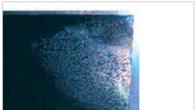
Bild 25: Verfärbung Absorberbeschichtung
