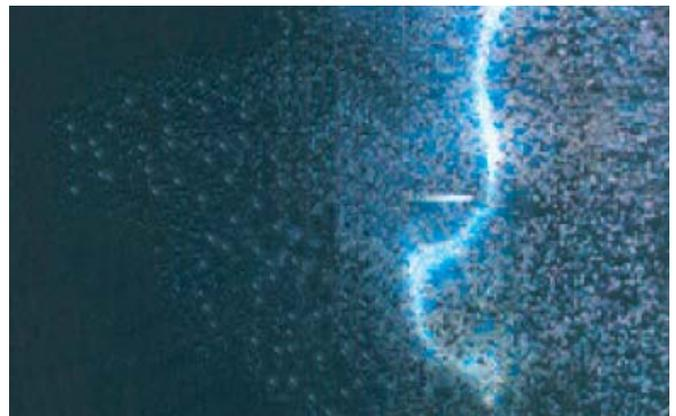
Bild 27: Verfärbung Absorberbeschichtung
