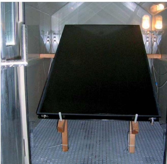
Bild 9: Anordnung des Kollektors in der Prüfkammer
