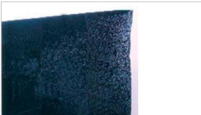
Bild 24: Verfärbung Absorberbeschichtung
