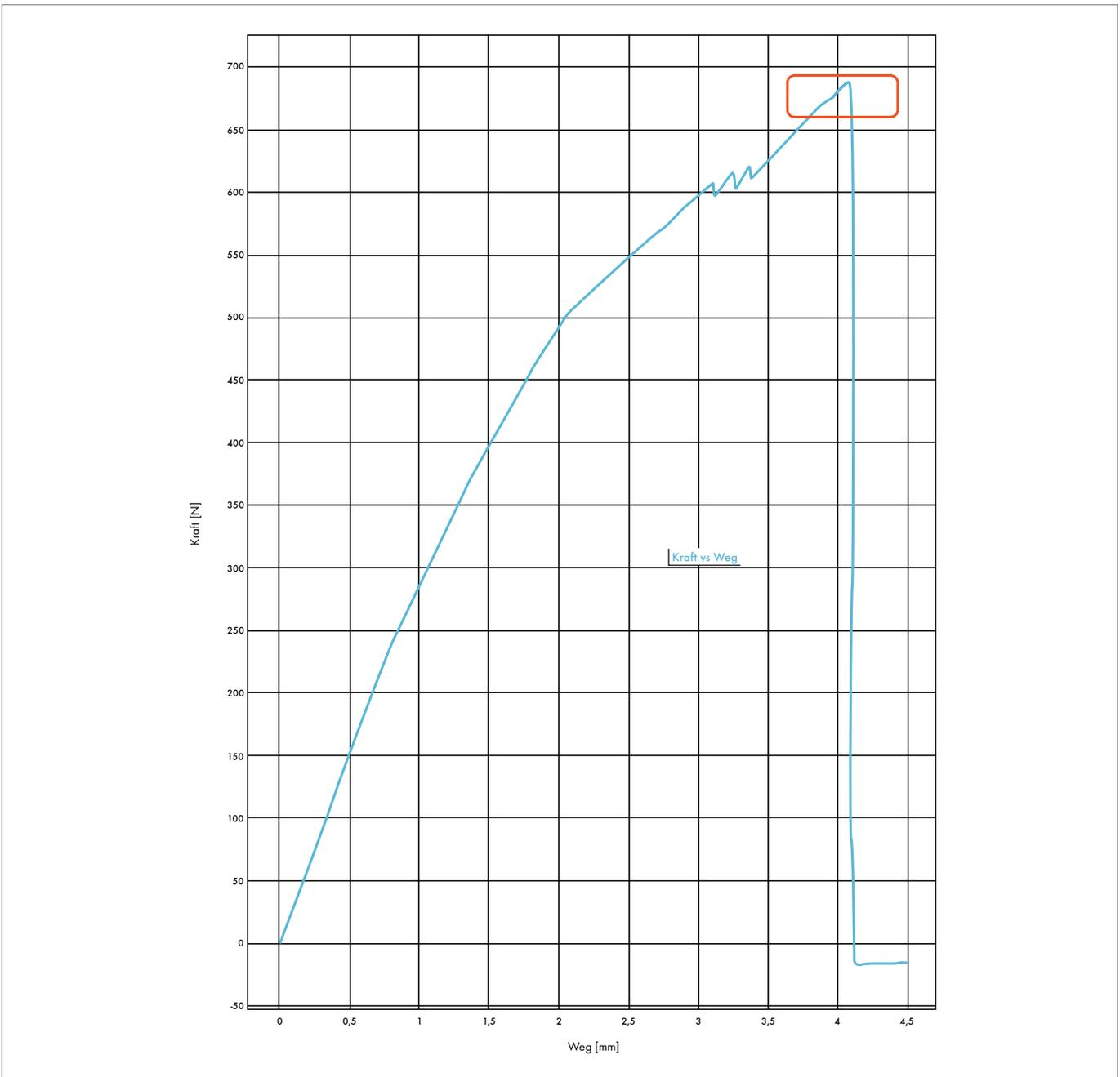
Abreißprobe Absorber Probe K
