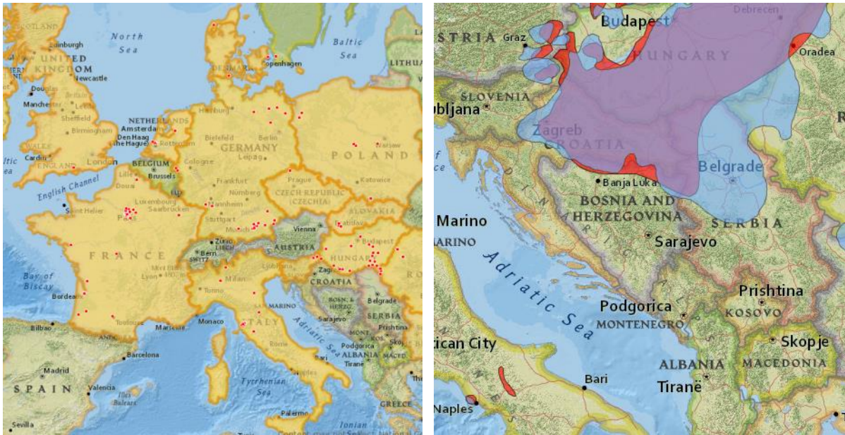
Slika 30. Karta koja pokazuje postojeće geotermalne (crvene tačke) CTS (lijevo), te potencijali iskorištavanja geotermalne energije (desno); Legenda: temperatura >50 °C na 1000 m dubine (plavo), temperatura >90 °C na 2000 m dubine (crveno), preklapanje ova dva područja (ljubičasto) (Izvor: http://map.mfqi.hu/geo_DH/ )
