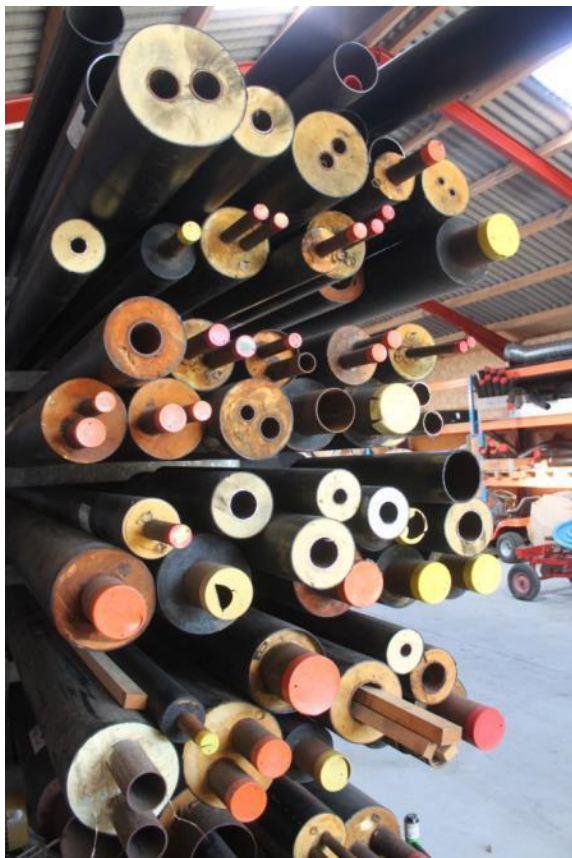
Slika 50. Primjeri starih jednocjevnih i dvocjevnih čeličnih cijevi (lijevo) te polimernih dvocjevnih cijevi (desno) (Izvor: Rutz D.)
