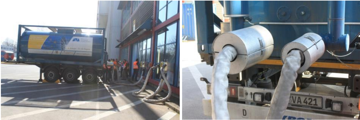
Slika 42. Kontejner za skladištenje topline u spalionici otpada (Augsburg, Njemačka) (Source: Rutz D.)
