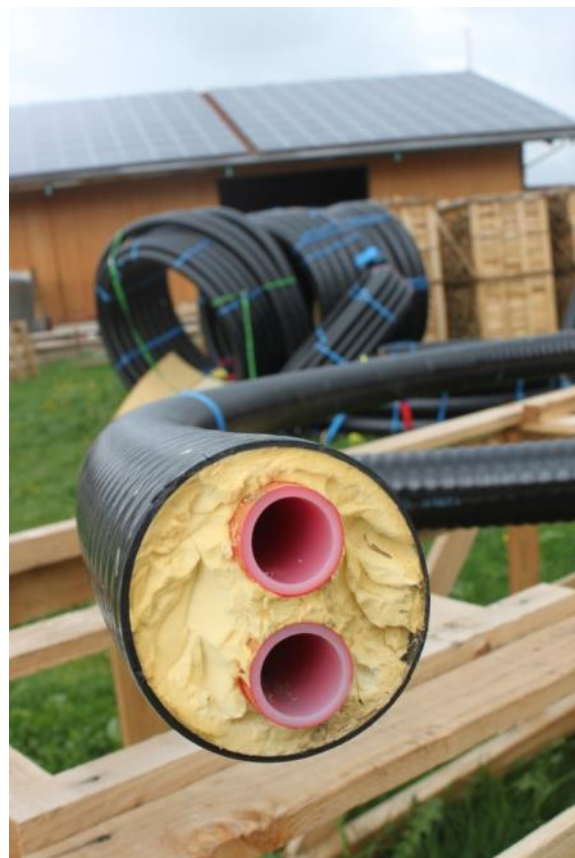
Slika 50. Primjeri starih jednocjevnih i dvocjevnih čeličnih cijevi (lijevo) te polimernih dvocjevnih cijevi (desno) (Izvor: Rutz D.)
