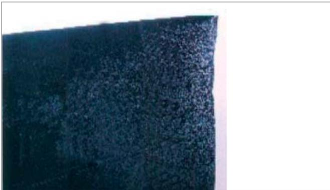
Bild 24: Verfärbung Absorberbeschichtung
