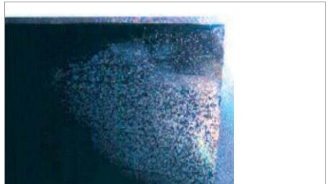
Bild 25: Verfärbung Absorberbeschichtung
