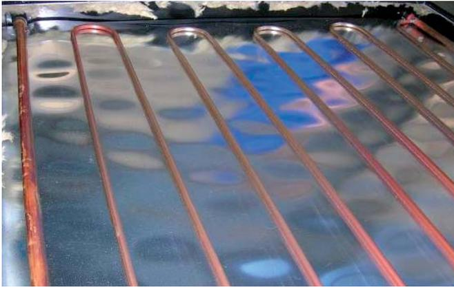
Bild 21: Verbindung Kupferrohre / Aluabsorber
